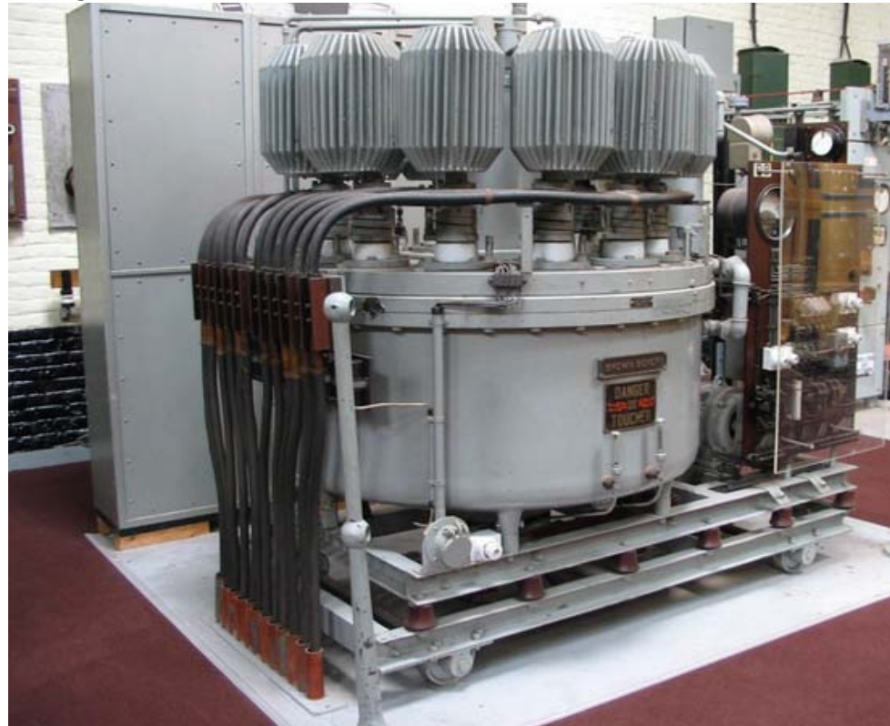
Diodo de vacío (izquierda) y Rectificador dodecafásico termo-iónico por vapor de mercurio (derecha).
