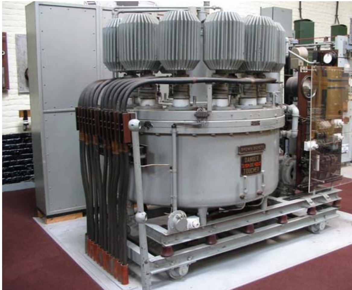
Rectificador termo-iónico por vapor de mercurio, arreglo conversor AC-DC dodecafásico en un solo "encapsulado" (cortesía Brown-Boveri)
